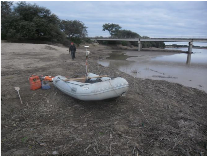
Prog. 0-100 m, margen argentina Vista del bote con ecosonda y GPS diferencial
